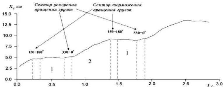
Рис. 5.4. Экспериментальный график движения центра масс инерцоида Толчина. Рисунок взят из работы /64/.
